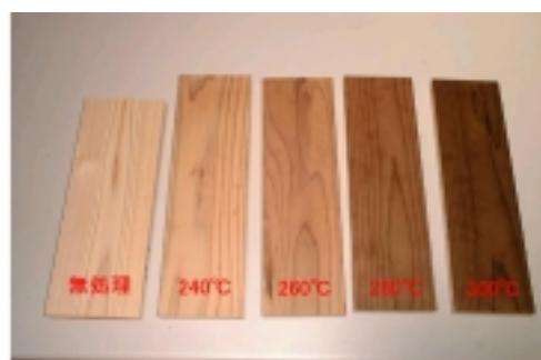
図5 処理温度別の表面圧密処理材の材色
