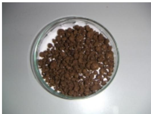
図5 回転式造粒器で作製したサンプル
