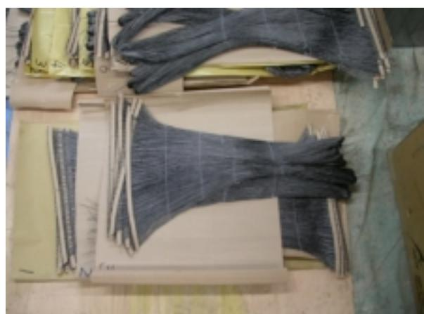
図4 共同開発したCFアンカー
