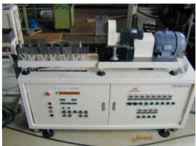
図1 二軸混練押出機
