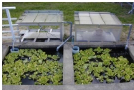
写真1 水生植物-光触媒併用分解実験装置
