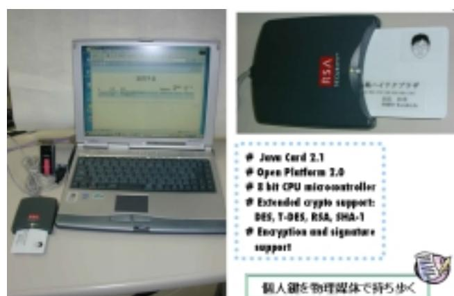
図 10 スマートカードを用いた認証システム
