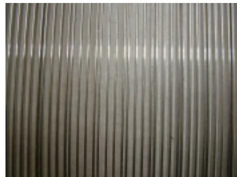
図 11 図 10 の拡大写真で筋の羽間隔が広い部分に炭素繊維が入り、狭い部分に水溶性繊維が入ります。
