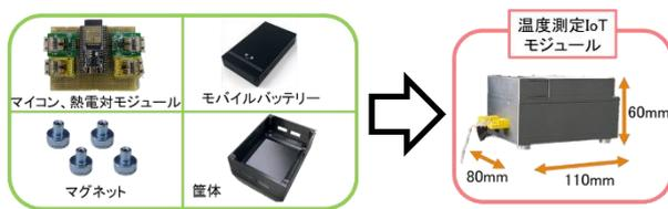
図3 温度測定 IoT モジュール
