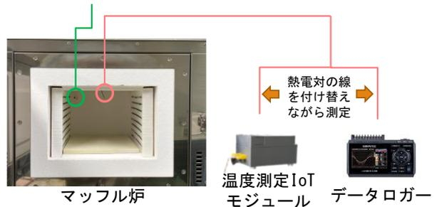
図4 温度測定実験の構成
