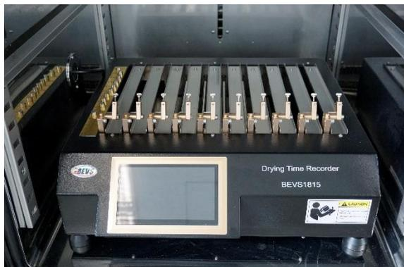
図2 塗膜乾燥時間測定機
