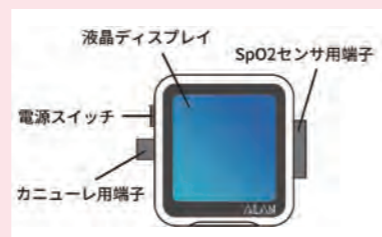
手首装着型の簡易PSG装置
