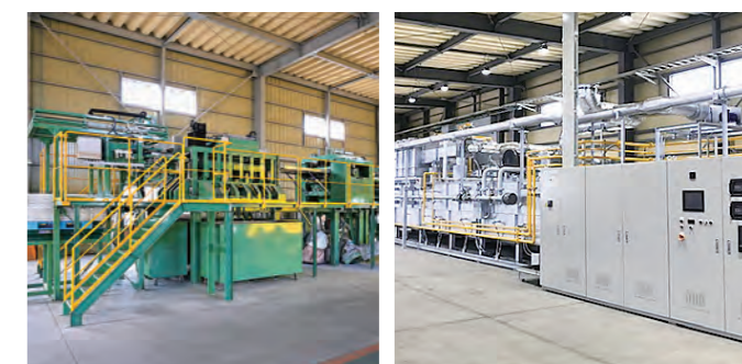
▲廃棄PVパネル自動仕分け機(高良) ▲日本初熱分解処理方式の高度リサイクルプラント(新菱)
