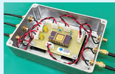
世界初となるダイヤモンド半導体デバイス試作品 (増幅回路)
