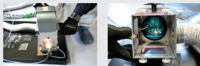
レーザー除染機による剥離作業 除染機のヘッド内部の様子
