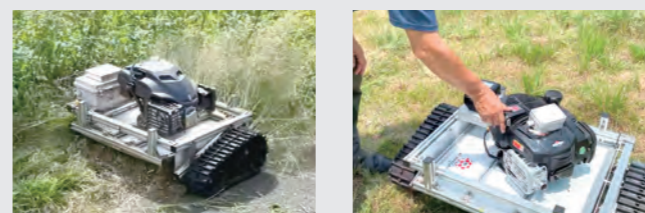
自立走行型農業用電動ロボットイメージ バッテリー装着の様子
