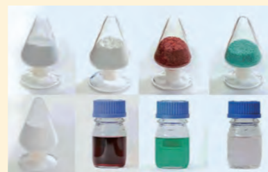
リチウムイオン電池(LiB)から再生したコバルト・ニッケル・リチウム等のLiB原料
