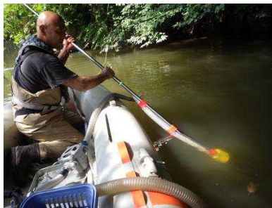
図3 エンジンポンプを用いた卵の採集試験 (左) ポンプとストレーナーの様子 (右) 吸引方法
