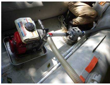
図3 エンジンポンプを用いた卵の採集試験 (左) ポンプとストレーナーの様子 (右) 吸引方法
