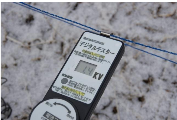
図 2-16 電圧チェック器材と漏電箇所
