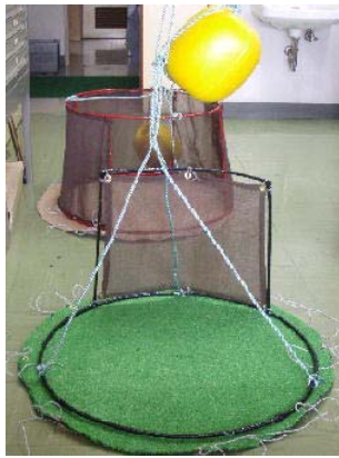
図1 試作した人工産卵床
