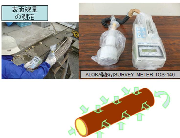
図-1 表面線量測定機器とほだ木の測定位置
