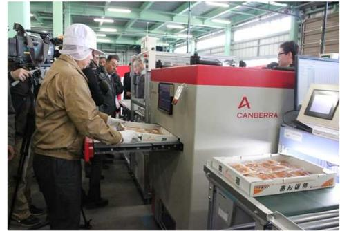
非破壊検査機器による全量検査の様子
