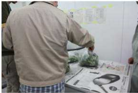
① 試料を調整する前にサーベイメーターにより放射能レベルを確認
