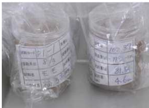
⑧ ゲルマニウム半導体分析器の汚染防止のため、容器をビニール袋で包む
