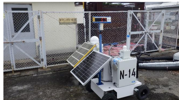
(写真8-1) MP-8に隣接して設置してある可搬型モニタリングポスト
