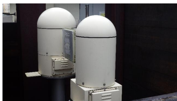
(写真 4 - 2) M P - 7 の放射線検出器（遮へい壁の内側）
