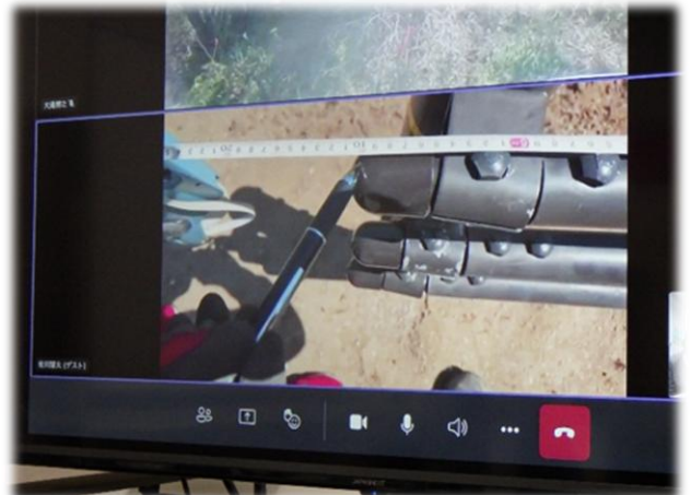
管理用道路防護柵の大画面での検査の様子
