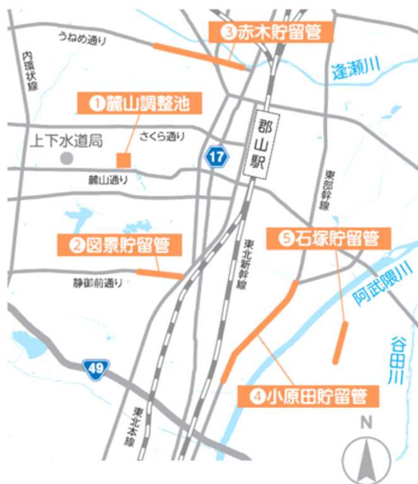
図 1.10 下水道（雨水貯留）施設（郡山市）
