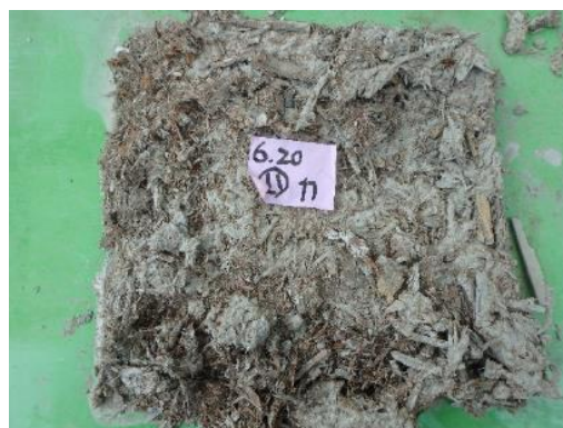
図－10 十分に固形化できなかった試作例
