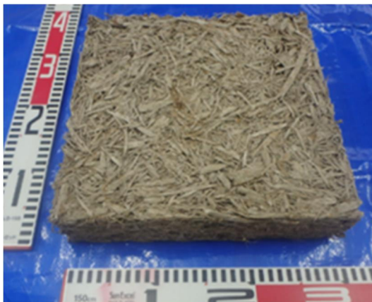
図-11 完成した試作品 バーク：セメント比（3：7）
