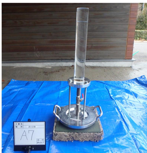
図-7 透水試験機の設置状況
