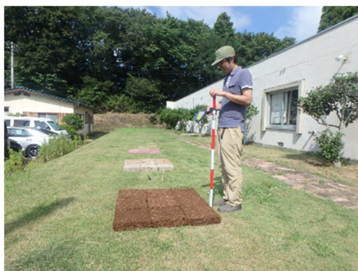
図－6 表面放射温度の測定状況
