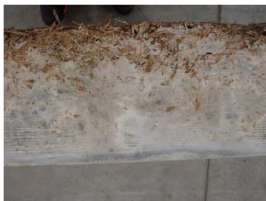
図－9 上下面で不均一な試作例
