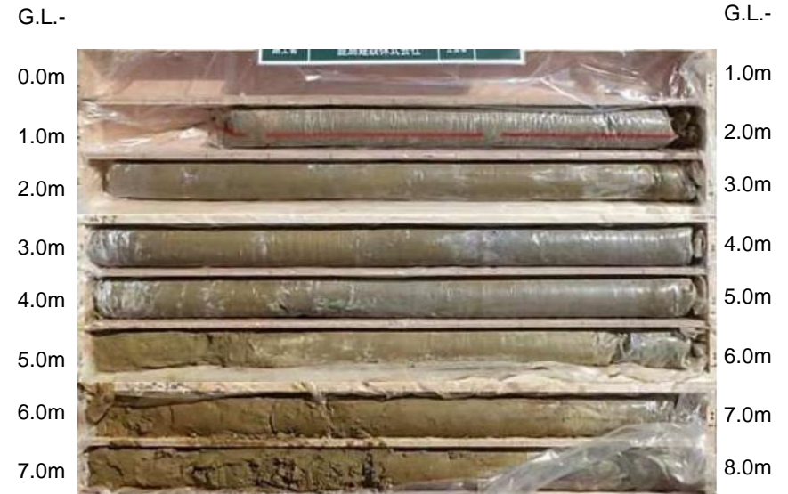
No.24-3-2 ボーリングコア
