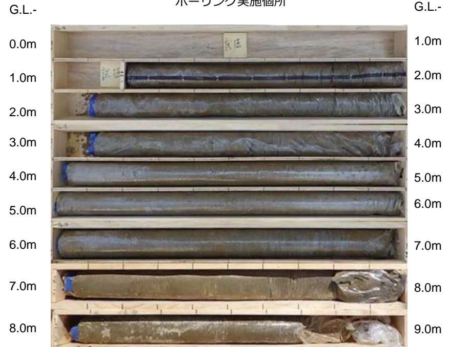
No.25-1-1 ボーリングコア
