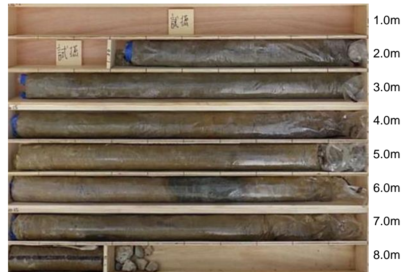
No.25-3-3 ボーリングコア
