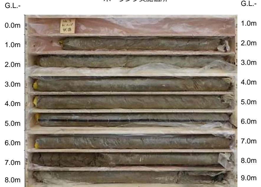
No.24-2-1 ボーリングコア
