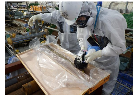
写真2 ボーリングコア表面線量測定状況 ※線量の低い2.5m盤で実施
