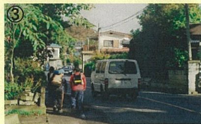
③ 路線名：棚倉矢吹線 事業名：交付金事業 場所：西白河郡中島村大字川原田地内 工事説明：県南地方の広域幹線道路であり、幅員狭小で線形が悪く、歩道も狭い区間を解消するため、バイパス整備を実施し、安全で円滑な交通を促進します。
