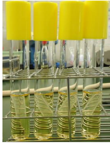
ダーラム管 入りの培地へ接種 (微生物が発生するガスをためる試験管のこと)
