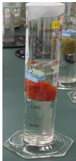
浸透圧の力で試料中の甘味料を抽出
