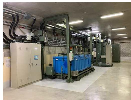
埋設される固体廃棄物ドラム缶が埋設基準を満たしているかを確認するための装置。
