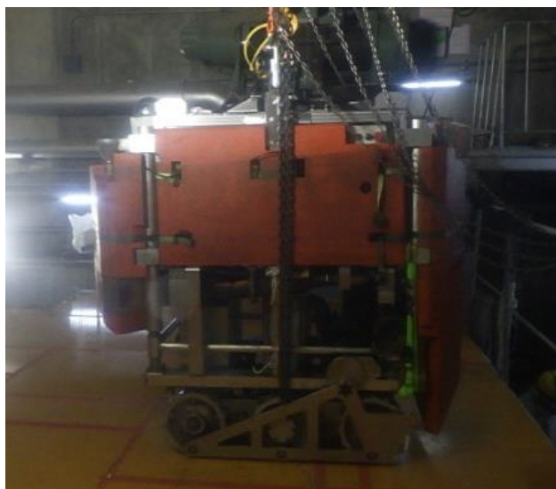
<HTI 1 階の集積作業用ROV（地下階投入前）> （3月5日 撮影）
