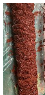
取り出したフィルタの状況 (赤色は酸化鉄)
