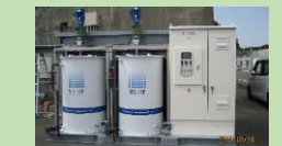
水産物の高鮮度保持技術（シャーベット氷製造装置）
