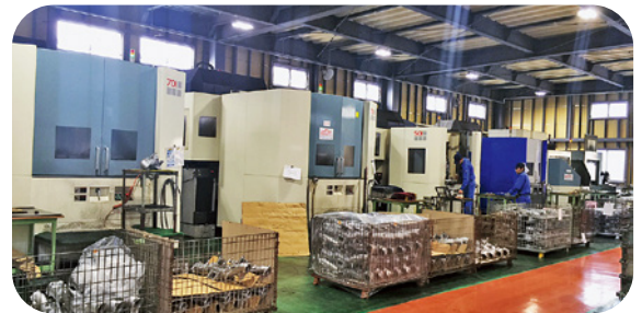
社内の横型マシニングセンターで最大のテーブルサイズ(630mm×630mm)の工作機械です
