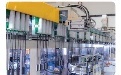
車載用サーモスタット性能検査設備
