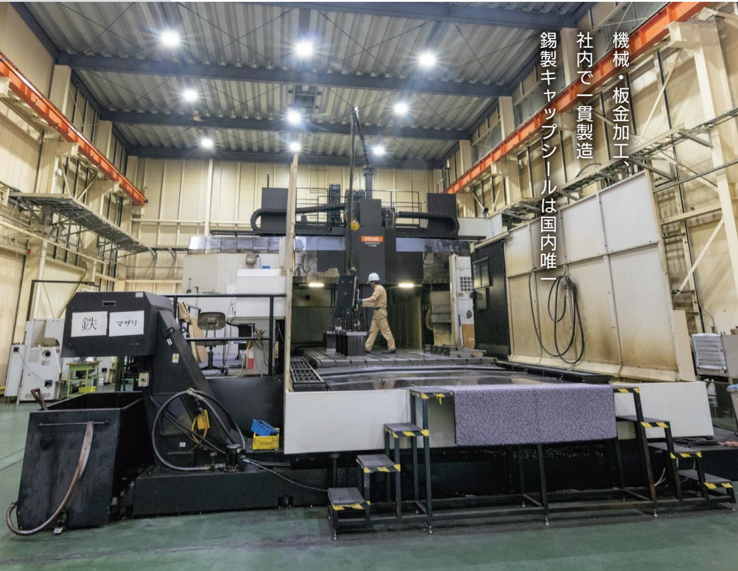
多面5軸加工門型マシニングセンタ ワークサイズ 3100mm×6000mm×1800mm 対応可能
