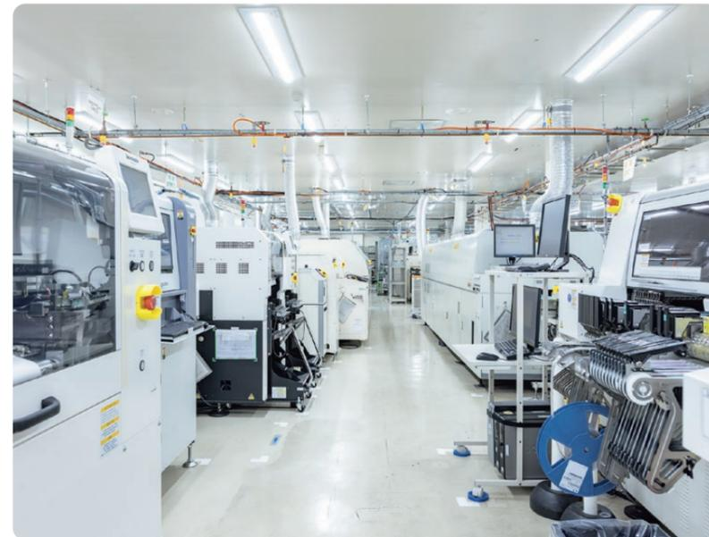
実装ライン（半田印刷、半田検査、部品実装、リフロー、実装外観検査）
