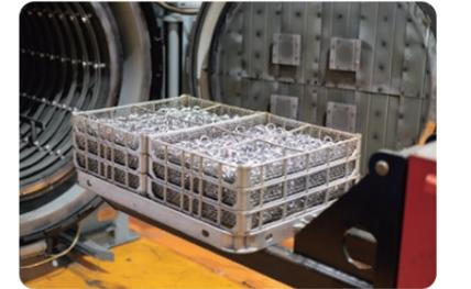
真空熱処理炉への製品の投入
