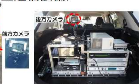
衛星通信装置
