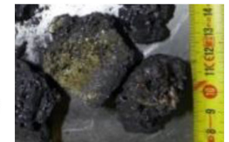
図4 アルゴン雰囲気中で製造したRPV模擬燃料デブリ
