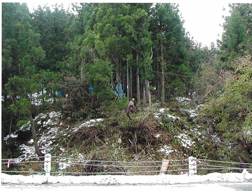
蓬萊地区地すべりブロック末端部の押し出し現象に伴う立木の傾倒状況
