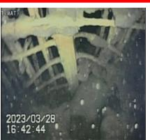
事故により溶け落ちた核燃料 (燃料デブリ) の試験的取り出しに向けた調査や準備が進められている。
