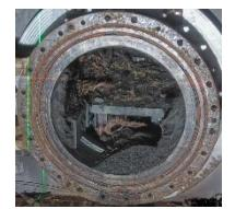
【1号機】2024年2月より小型ドローンによる原子炉格納容器内部の気中調査が開始された。
