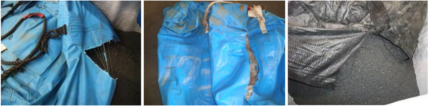
フレキシブルコンテナ ランニング J 形 1 種・3.9 年使用 (S 社) (本体生地 (胴 接合部以外) より破袋)
