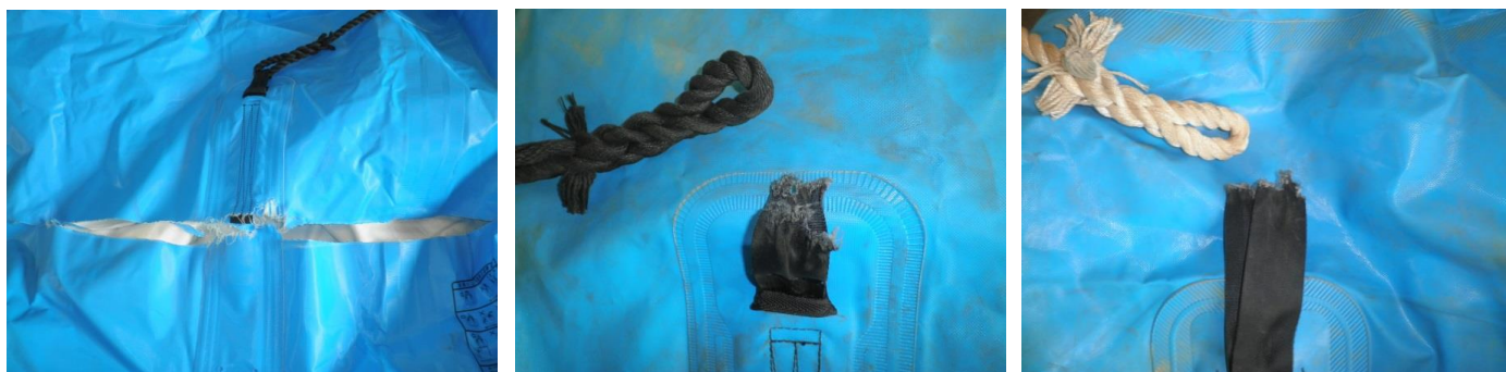
フレキシブルコンテナ ランニングJ形1種、左から 未使用品（S社）、3.9年使用（S社）、4.8年使用（V社） （未使用品はベルト下部の本体生地から破袋、他は吊ベルトが破断）
