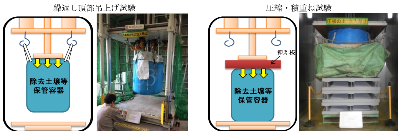
図5 JIS Z 1651 に基づく袋体性能試験のイメージ
