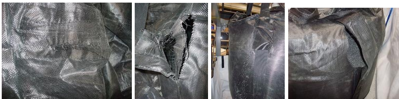
耐候性大型土のう（A社）左から 未使用品、2.7年使用、3.5年使用、4.8年使用 （全て、吊ベルト縫製部から破袋）
