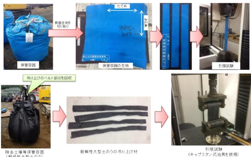
図4 引張試験の手順（保管容器生地または吊ベルト）
