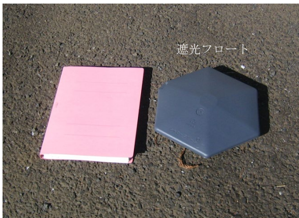
写真-18.3 遮光フロート (左はA4版ファイル)
