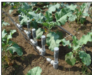
写真-5.1 テンシオメータ設置状況
