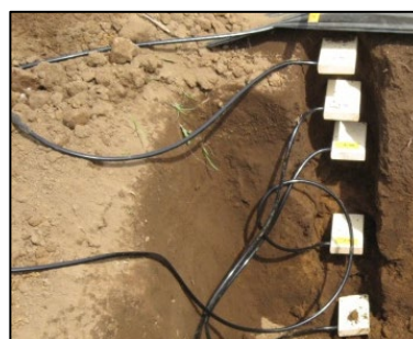
写真-5.2 誘電率水分計（TDR法）設置状況
