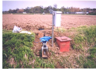
写真-6.3 落水口側設置例
