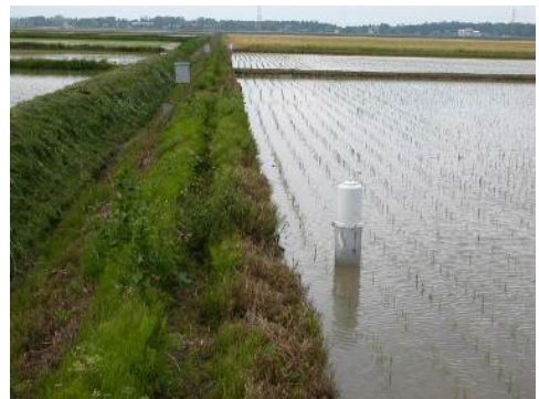
写真-6.5 自記水位計設置例
