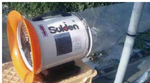
図Ⅲ-65 株間局所送風に使用する送風機
