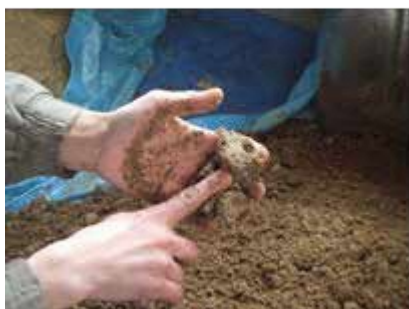
図Ⅲ－６ 水の添加程度 手で握ると固まり、指で軽く押すと崩れる程度に水を加える
