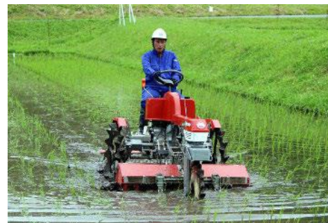
図Ⅲ-33 ミッドマウント水田用除草機
