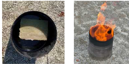
図4 ロックウールを芯材とした例
