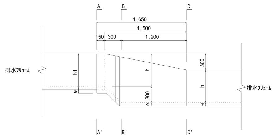
排水路階段落差工断面図
