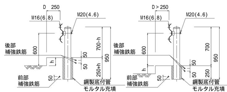
補強鉄筋形状図
