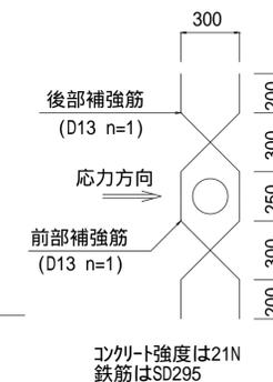
補強鉄筋形状図
