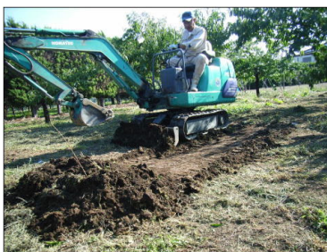
図22 バックホー(排土板利用)
