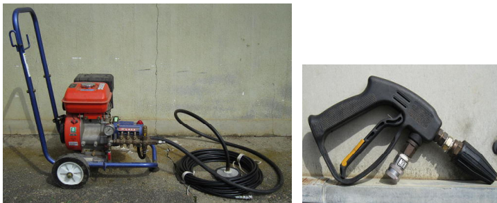
図2 高圧洗浄機ともも水圧摘らい用の旋回ノズル（ハンドガンタイプ）
