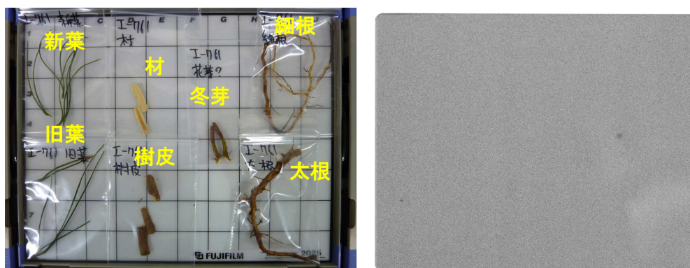
図 イメージングプレート上の苗の各部の配置 (左) と120時間曝露後のイメージングプレート (右)
