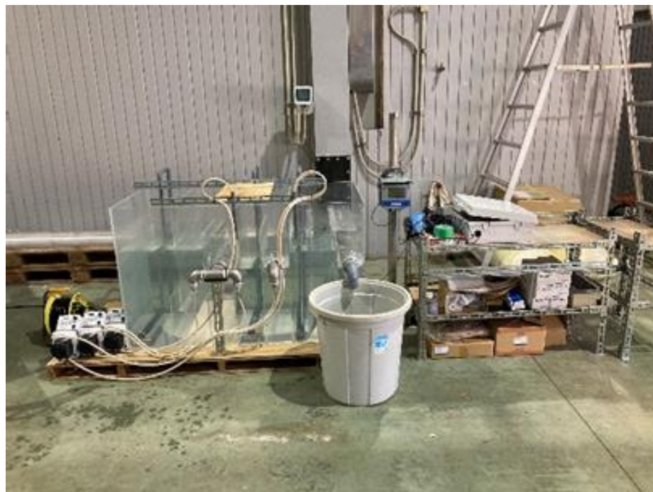
アナモックス菌を使った、消化液処理装置の試作機
