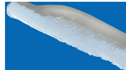
着氷によるブレード破損、発電停止
