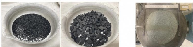
左：竹製炭素骨材（小粒・大粒） 右：炭素骨材で脱炭素化されたフレッシュモルタル
