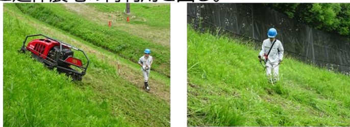
リモコン式草刈り機（左）と刈り払い機（右）による除草作業の実証
