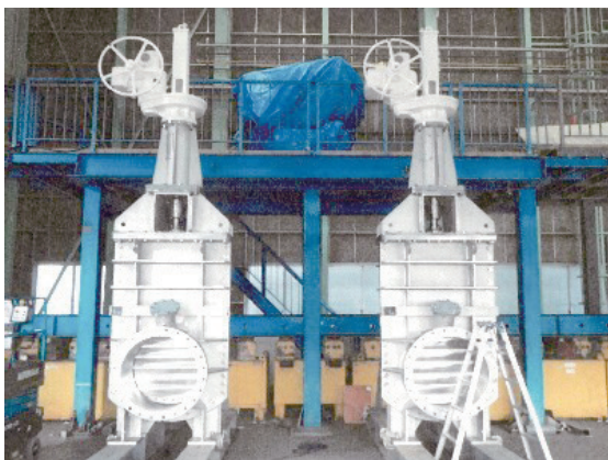
【高柴ダム】低水放流設備制作状況
