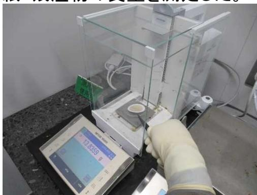
ろ紙+残渣物質量測定(試料ろ過後)
