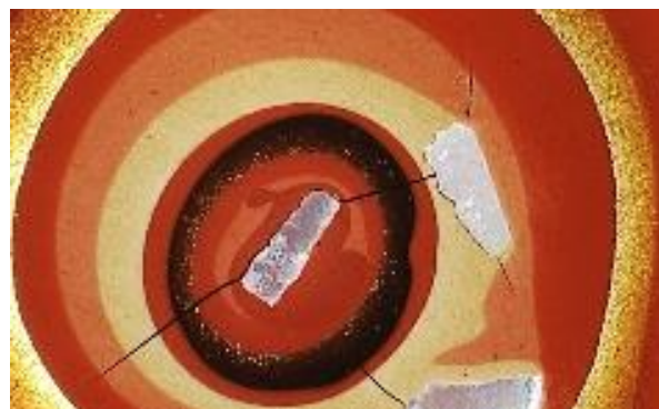
図1 螺鈿を起点としてクラック (35倍で観察)
