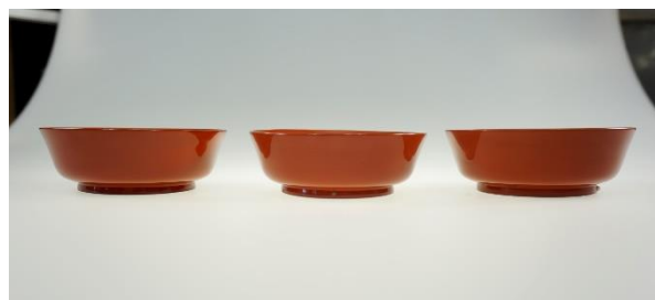
図3 1000回洗浄前後の手塩皿 (左：洗浄前、中：500回洗浄、右：1000回洗浄)
