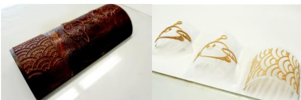
図 8 曲面への貼り付け試験(半円柱: 直径 100[mm])
