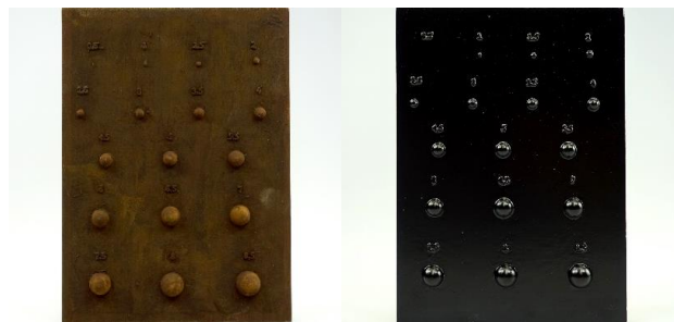
図 10 錆下地(左)と漆塗装した(右)半球サンプル
