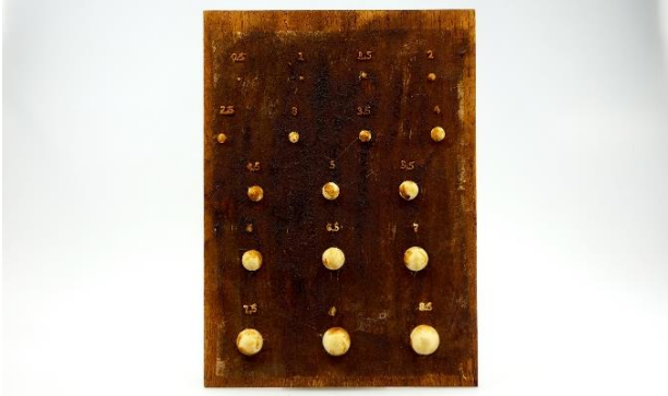
図 7 半球サンプルの貼り付け試験(乾燥後)
