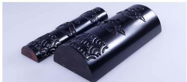
図 11 漆で塗装した半円柱サンプル
