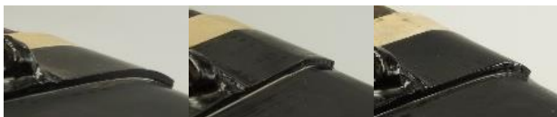
図 1 2 塗装まで施した 3 種類の竹塗加飾データ (スリットなし：左、天面ありスリット：中、スリット：右)
