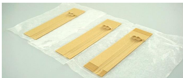
図6 出力した3種類の竹塗加飾（スリットなし：左、天面ありスリット：中、スリット：右）
