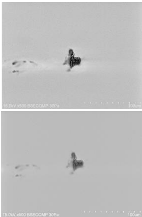
図6 UFB+アルカリ電解水洗浄での模擬汚染の変化 (上：洗浄前，下：洗浄後)
