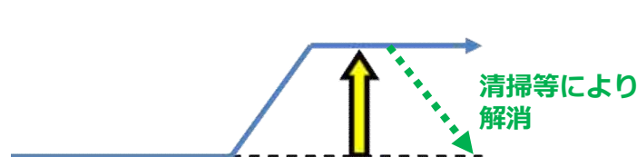
(2) 海生生物の付着、フォールアウトの堆積等により指示値が上昇し、高止まりする場合。 (清掃等により通常値に復帰)
