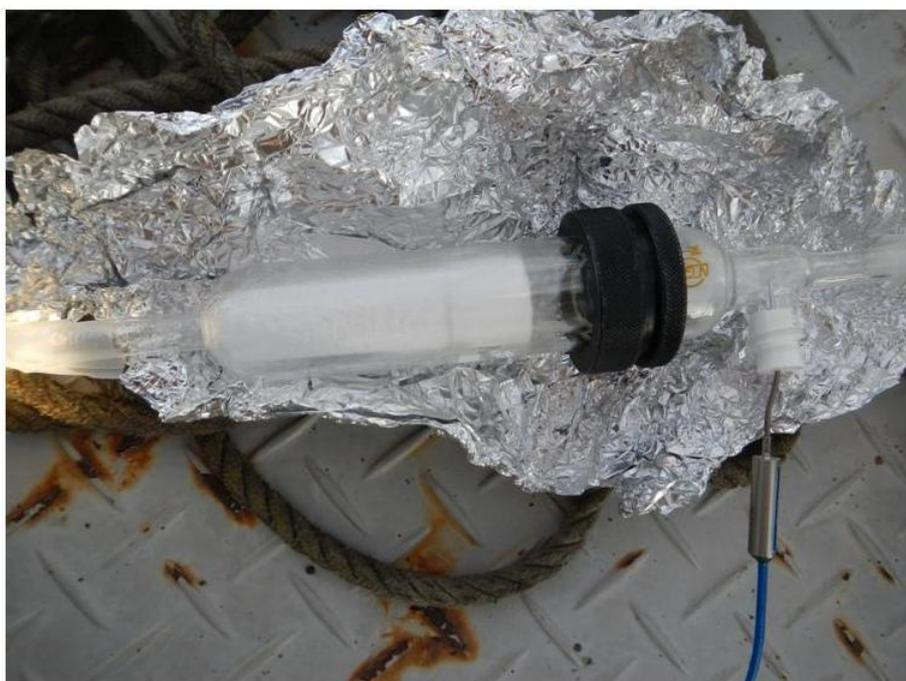
写真1 円筒ろ紙が外れたフィルタ捕集部の状況
