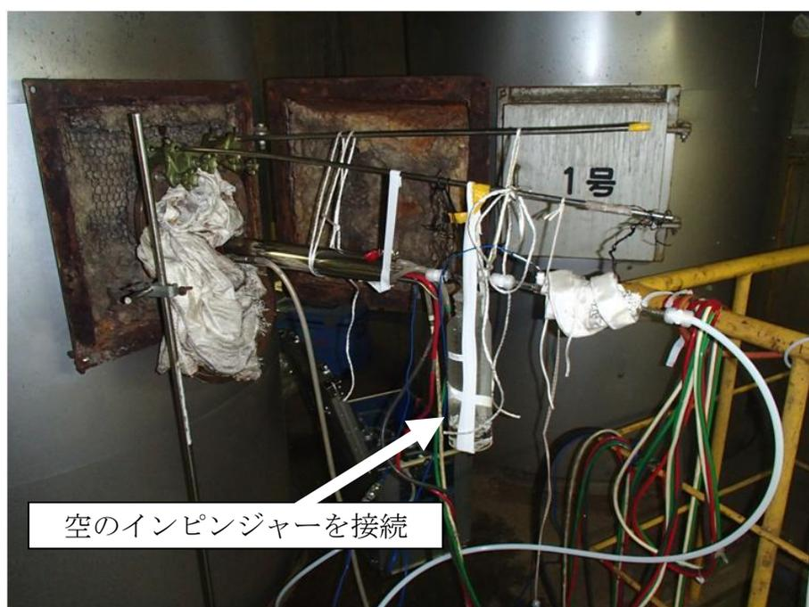
写真2 ダイオキシン類の試料採取状況
