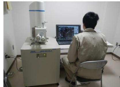
図2 電子顕微鏡
