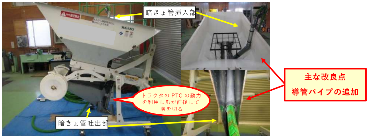
図 小型浅層暗渠施工器
