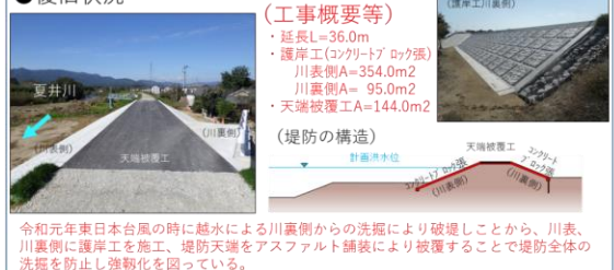
(被災概要等) ・破堤延長L=36.0m
