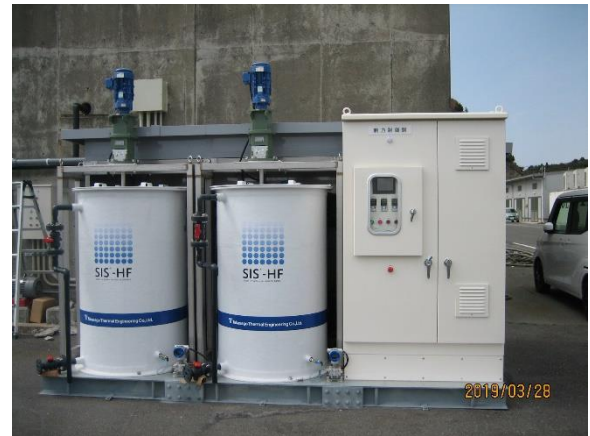
水産物の高鮮度保持技術の導入（シャーベット氷製造装置）
