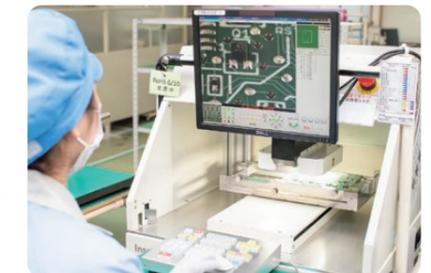
自動外観検査（AOI）による判定結果を基に目視で合否判定する目視支援検査
