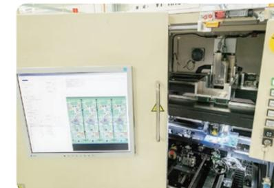
リフロー処理後の回路基板のはんだ付け状態を検査する自動外観検査（AOI:Automated Optical Inspection）
