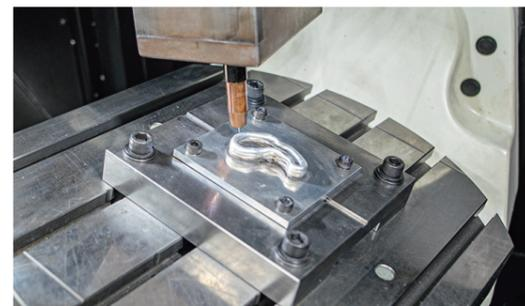
ワイヤーアーク(WAAM)方式による金属積層造形の様子
