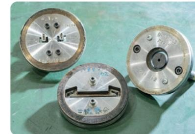
自社設計による押出成形用金型（口金）の例
