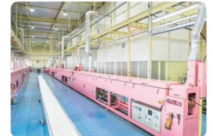
押出成形されたゴム製品（素材）を加硫処理するマイクロ波（UHF）連続加硫装置
