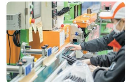
加硫処理されたゴム製品（素材）の切断工程（規定寸法に切断して製品が完成する）
