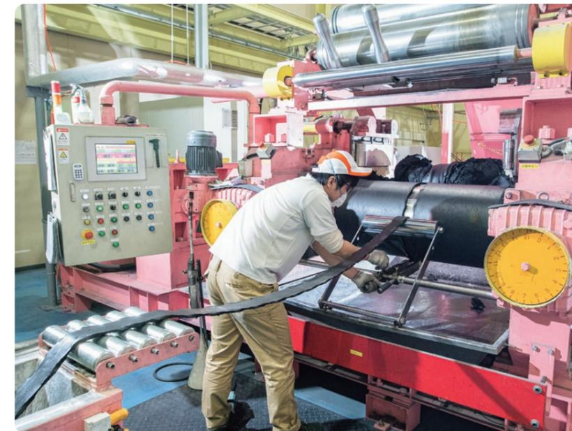
オープンロールで混練りしたゴムをシート状に切り出す分出し作業。この後、分出ししたゴム（コンパウンド）を熟成する（一定時間以上覆かせて、内部の応力歪みを取り除き、温度を降下させる）。
