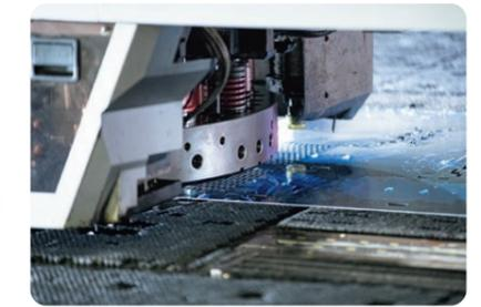
パンチプレス加工による板金ブランク材の打ち抜き加工（金属板に穴を開ける加工）
