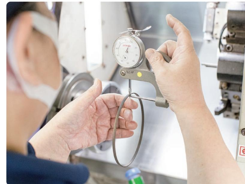
加工時のワーク（素材）把持が難しい薄厚リング製品（樹脂材）の旋盤加工時検査の様子（ダイヤルシックスネーゲージによる板厚検査）
