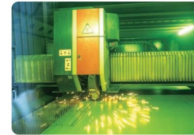
レーザー加工による板金ブランク材の切断加工（金属板素材から折り曲げ加工前の状態の金属板を切断する加工）
