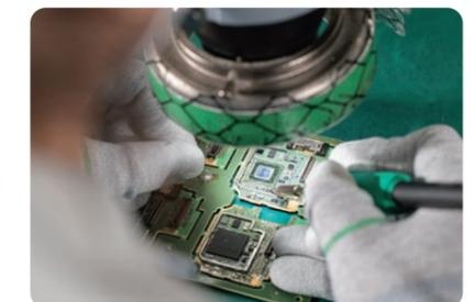
リワーク作業（実装不良箇所の部品交換）を支える手付け実装（手はんだ付け）技術
