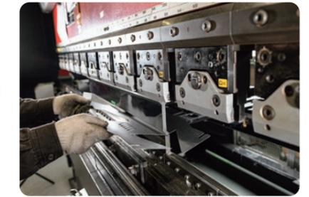
ベンダー（プレスブレーキ）加工による板金ブランク材のV曲げ加工（突き曲げ）
