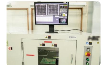
リフロー処理前の電子部品装着位置、リフロー処理後はんだ付け状態を透視検査するX線透視検査
